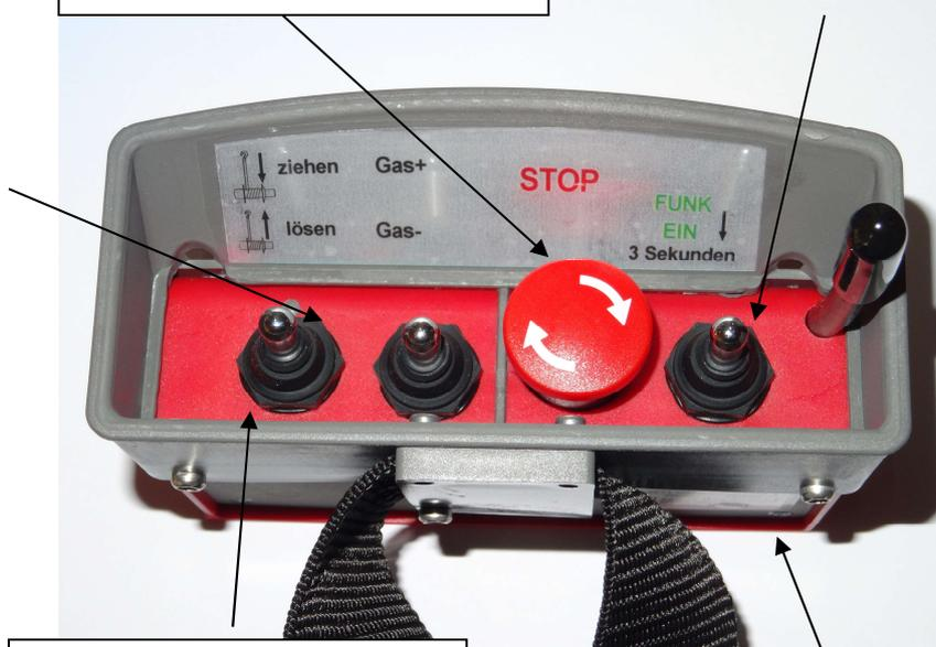
Funktion "Winde lösen" geht bei einer Betätigung länger als 3 Sekunden in Selbsthaltung (Dauerlösen)
