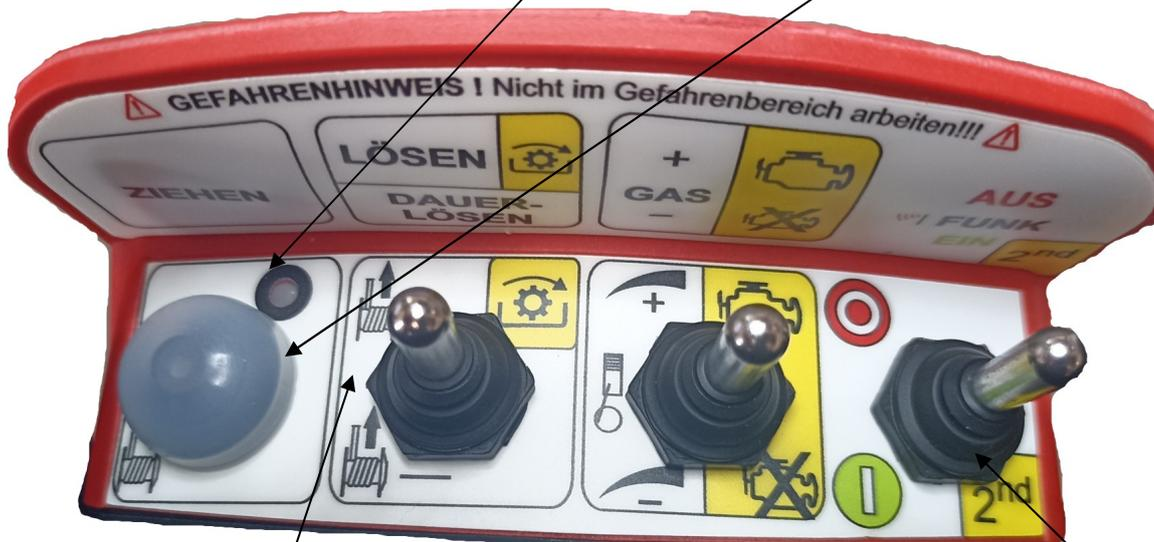
Lösen – nach oben drücken -Kurzlösen (löst solange die Taste gedrückt wird)
